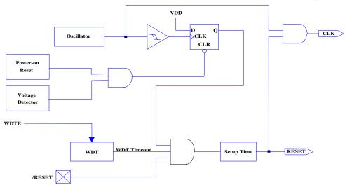
Fig. 29. Controller Reset Block Diagram
